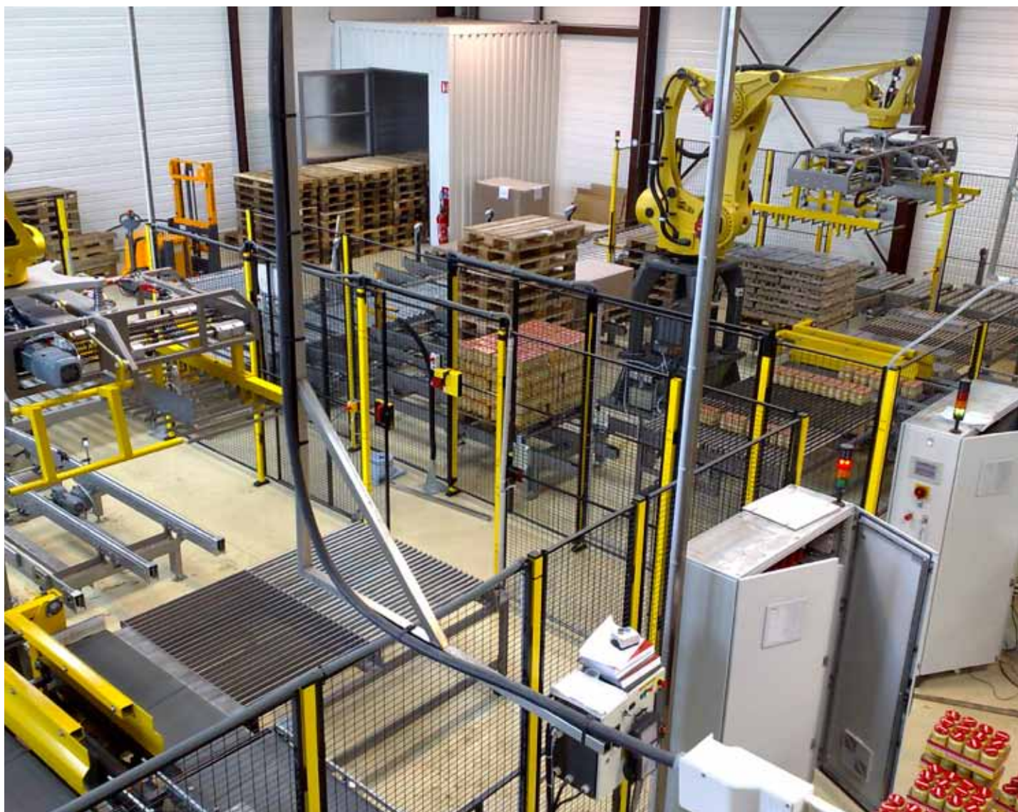
Axelent X-Guard®, wysokość 2 300 mm. Zdjęcie przedstawia 25 m ogrodzenia ochronnego otaczającego robota i palety.
