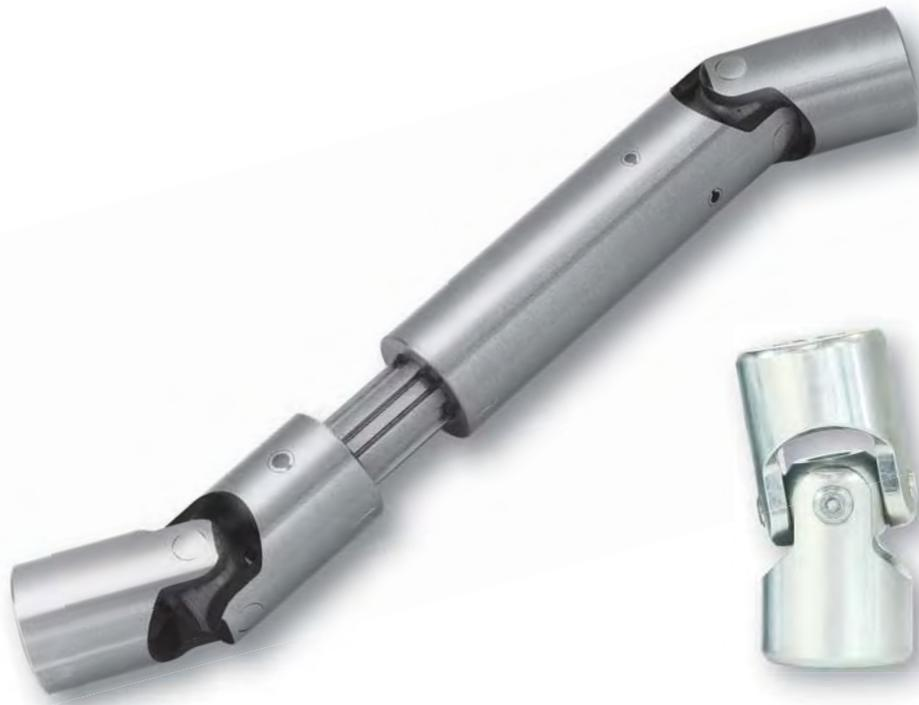
Kreuzgelenke und Kreuzgelenkswellen nach DIN 808 sind gleitgelagert und infolgedessen ist der Einsatzbereich auf langsam laufende Antriebe beschränkt.
