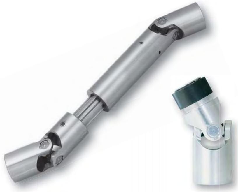
Nadelgelagerte Präzisions-Wellengelenke und Gelenkwellen nach DIN 808 werden dort eingesetzt, wo eine präzise Kraftübertragung bei hoher Drehzahl (bis  $5000 \text{ min}^{-1}$ ) gewährleistet sein soll.
